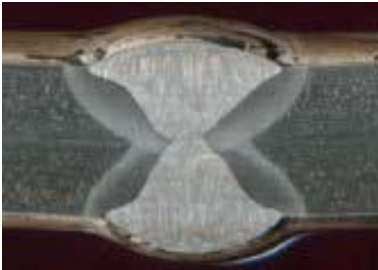
Vid provsvetsningar kan makroprover användas för kartläggning av sambandet mellan parameterinställningar och svetsmetod samt för att i förekommande fall studera diskontinuiteter. Foto: FORCE Technology Sweden AB
